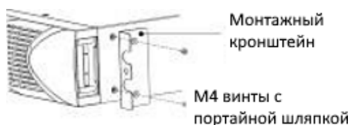
Рисунок 2-6. Установка монтажных кронштейнов
