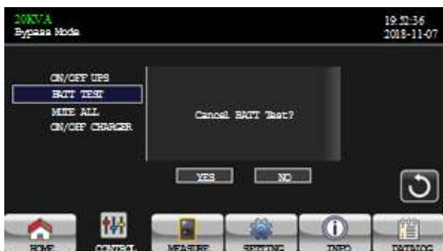
Отменить испытание батареи
