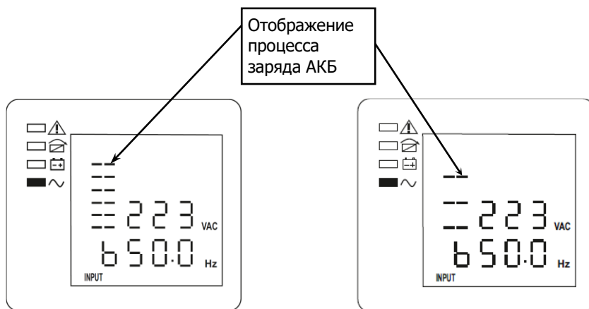
Рисунок 21 – ЖК-дисплей, форсированный (ускоренный) заряд АКБ
