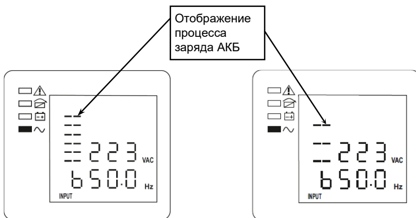
Рисунок 16 — ЖК-дисплей, форсированный (ускоренный) заряд АКБ
