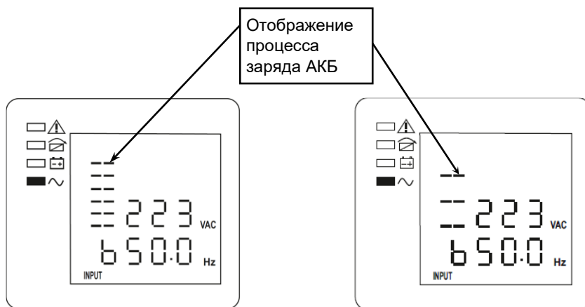
Рисунок 21 – ЖК-дисплей: форсированный (ускоренный) заряд АКБ
