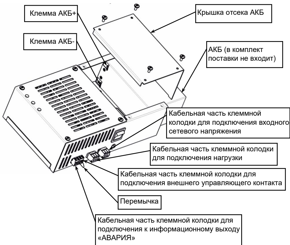
Рисунок 3 — Расположение АКБ и кабельных частей колодок
