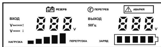
Рисунок 3 — Светодиодный графический индикатор.
