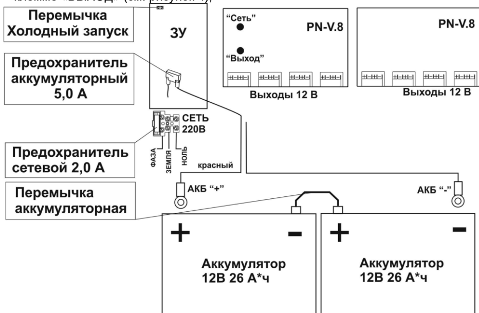
Рисунок 3 - Расположение органов коммутации, управления и защиты в изделии
