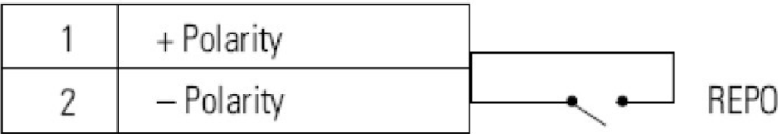
Рис.16 — Схема контактов разъема REPO
