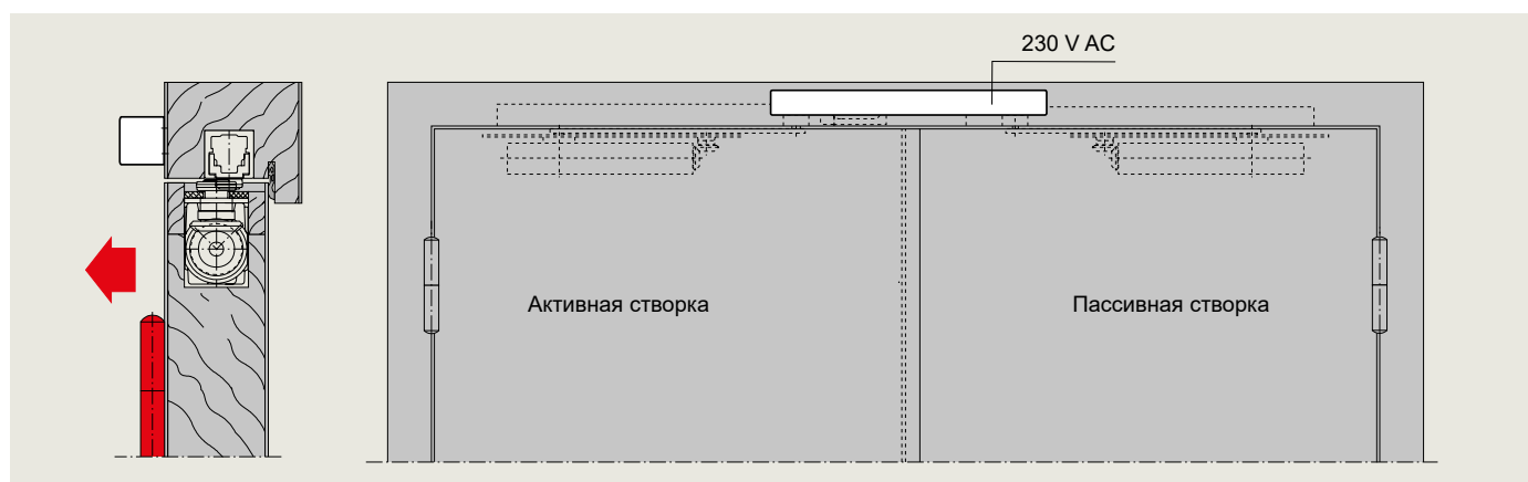
Датчики дыма пожарной сигнализации RMZ со стороны петель вместе с ITS 96 GSR-EMF Пример: дверь DIN-L, дверь DIN-R в зеркальном отражении.
