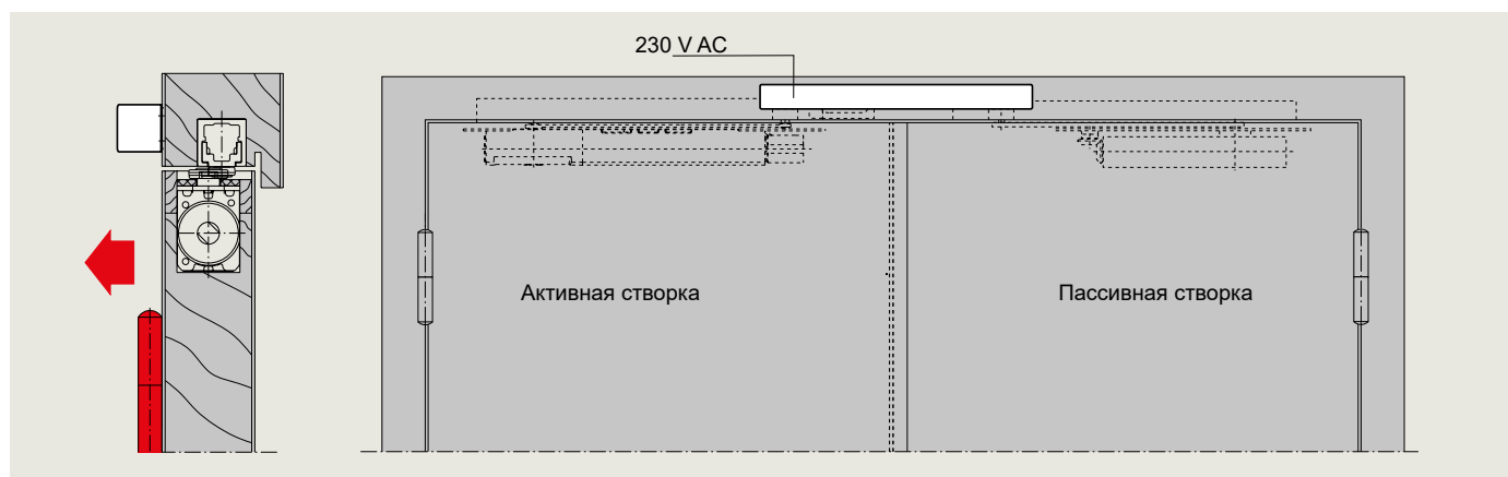
Датчики дыма пожарной сигнализации RMZ со стороны петель вместе с ITS 96 FL GSR Пример: дверь DIN-L, дверь DIN-R в зеркальном отражении.
