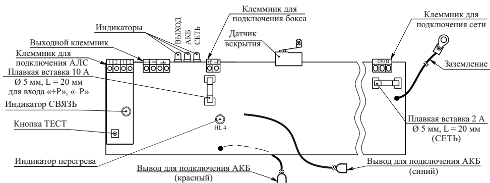
Рисунок 3 – Плата источника ИВЭПР 24/2,5 RS-R3
