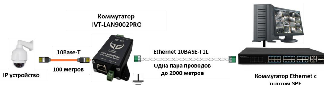
Рис. 5 Типовая схема подключения удаленного IP-устройства с помощью IVT-LAN9002PRO
