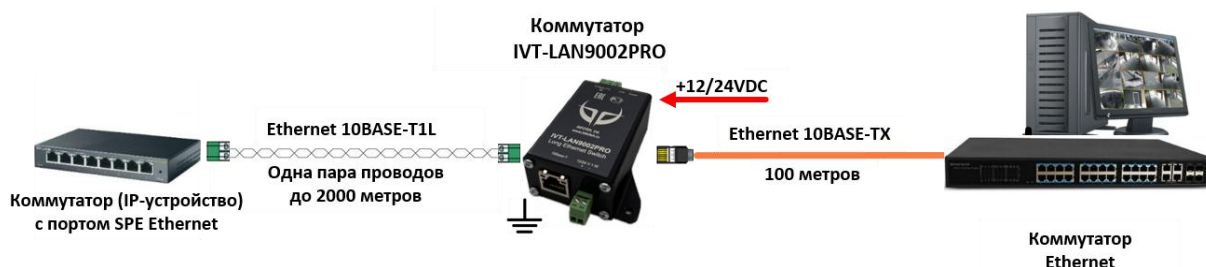
Рис 1. Схема подключения устройств к портам коммутатора IVT-LAN9002PRO
