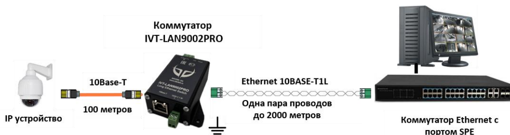
Рис. 2 Типовая схема подключения удаленного IP-устройства с помощью IVT-LAN9002PRO
