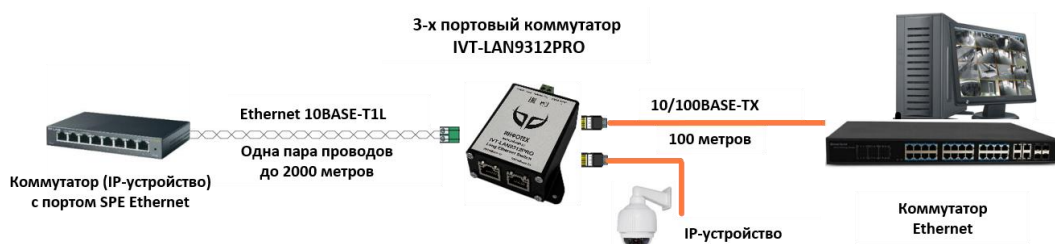
Рис. 5 Типовая схема подключения удаленного сегмента сети Ethernet с помощью IVT-LAN9312PRO и дополнительной видеокамеры в базовом сегменте
