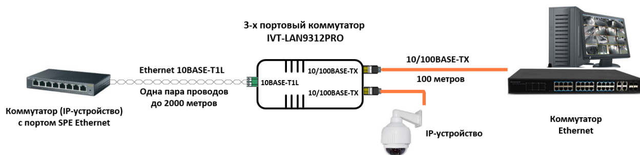
Рис 1. Схема подключения устройств к портам коммутатора IVT-LAN9312PRO
