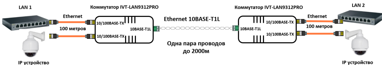
Рис. 5 Типовая схема объединения сегментов сети Ethernet и подключения IP-устройств с помощью Удличителя IVT-Long-IP Double по двум проводам на удаленности до 2 км. друг от друга
