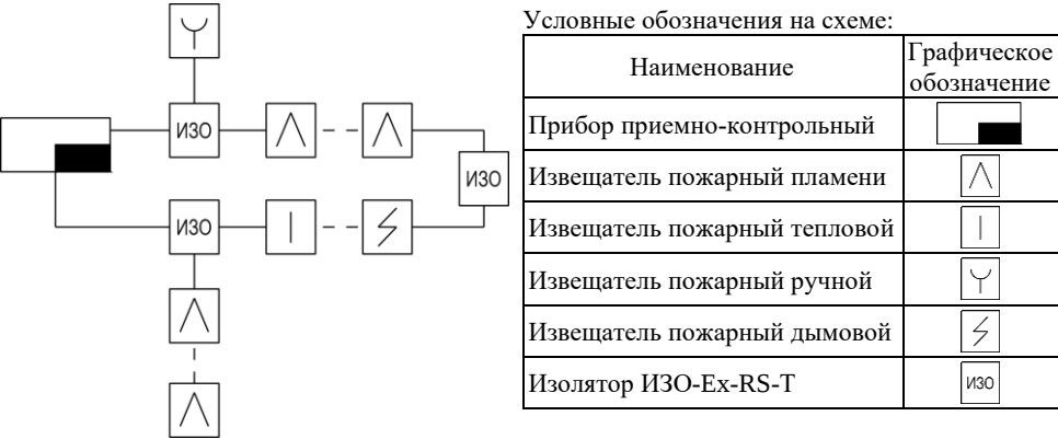
Рисунок 3 – Условная схема включения изолятора в АЛС
