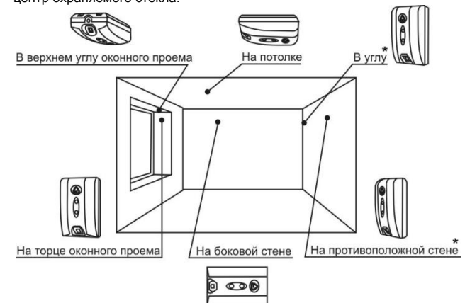
Рис.2 Возможные варианты установки извещателя
