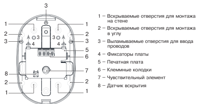
Рисунок 2 – Основание с установленной печатной платой
