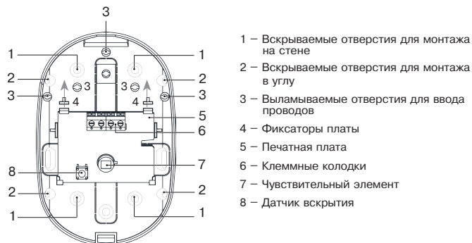
Рисунок 2 – Основание с установленной печатной платой
