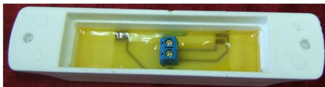
ИО 102-26 исп.01 АЯКС (внутренний разъём DG3)
