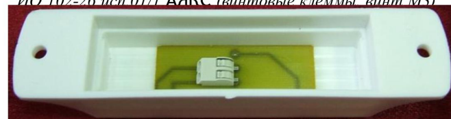
ИО 102-26 исп.01/2 АЯКС (клеммы экспрессмонтажа)
