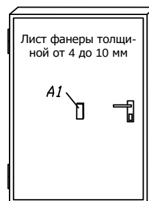
Рисунок 6. Защита деревянной пустотелой двери
