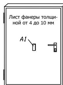
Рисунок 6. Защита деревянной пустотелой двери
