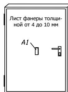
Рисунок 6. Защита деревянной пустотелой двери
