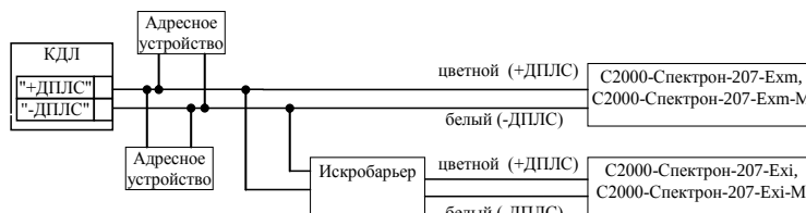
Рис. 2 – Типовая схема включения извещателя в двухпроводную линию связи КДЛ
