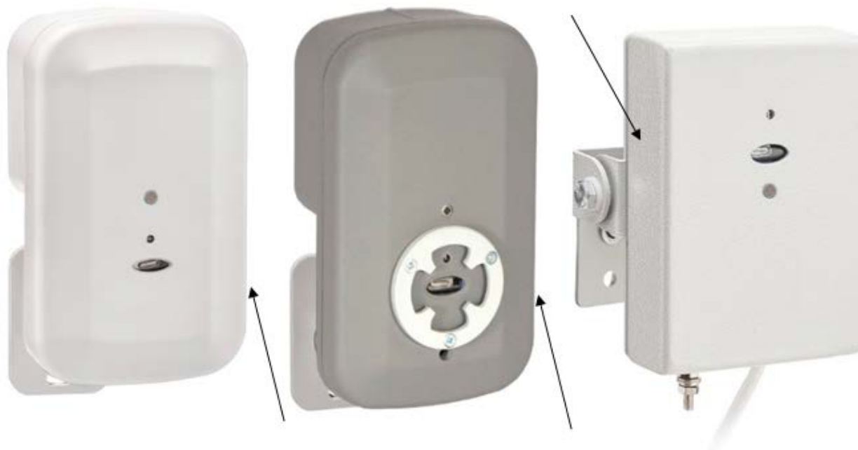
Рисунок 3. Место поднесения магнита
