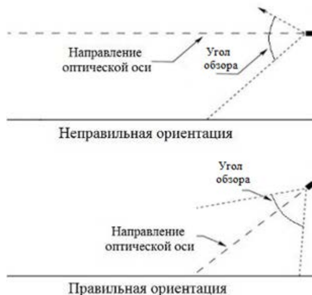
Рисунок 4 – Установка извещателя по отношению к горизонту
