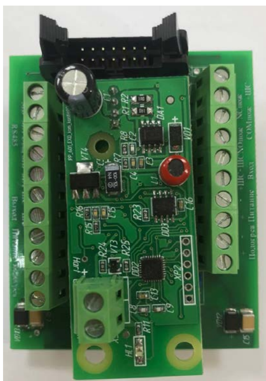
Рисунок 5 – Клеммная плата извещателя
