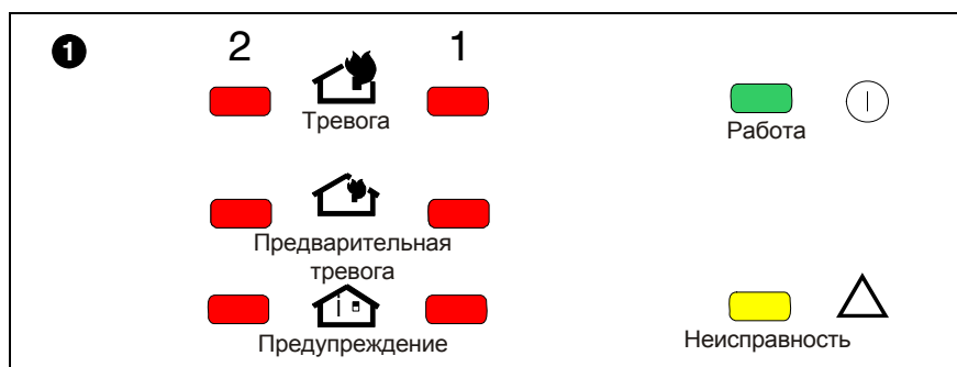
Рис. 2.6: Индикация TITANUS® (пояснения см. № 1 в таблице на следующей странице)
