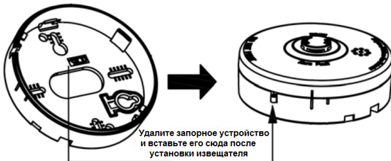
Рисунок 2.2.4.6 – Защёлка, защищающая от несанкционированного доступа
