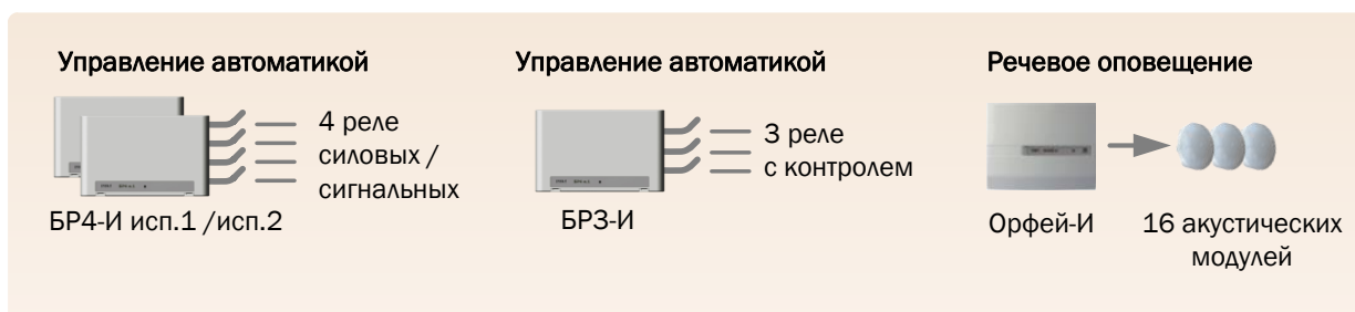
Рисунок 20 Исполнительные устройства S2
