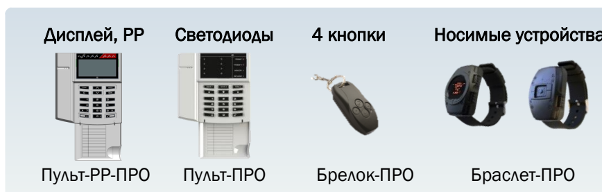
Рисунок 16 Виды радиоканальных устройств управления
