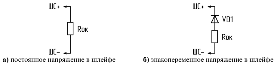
Рисунок 10. Оконечный элемент контроля шлейфа ППКП.
