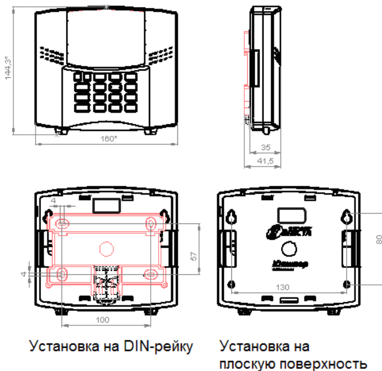
Рисунок 2. Габаритные и установочные размеры прибора
