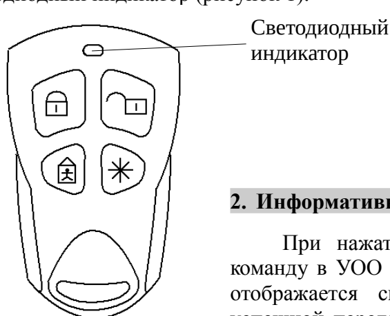
Рисунок 1 - Внешний вид радиобрелока Юпитер-6371
