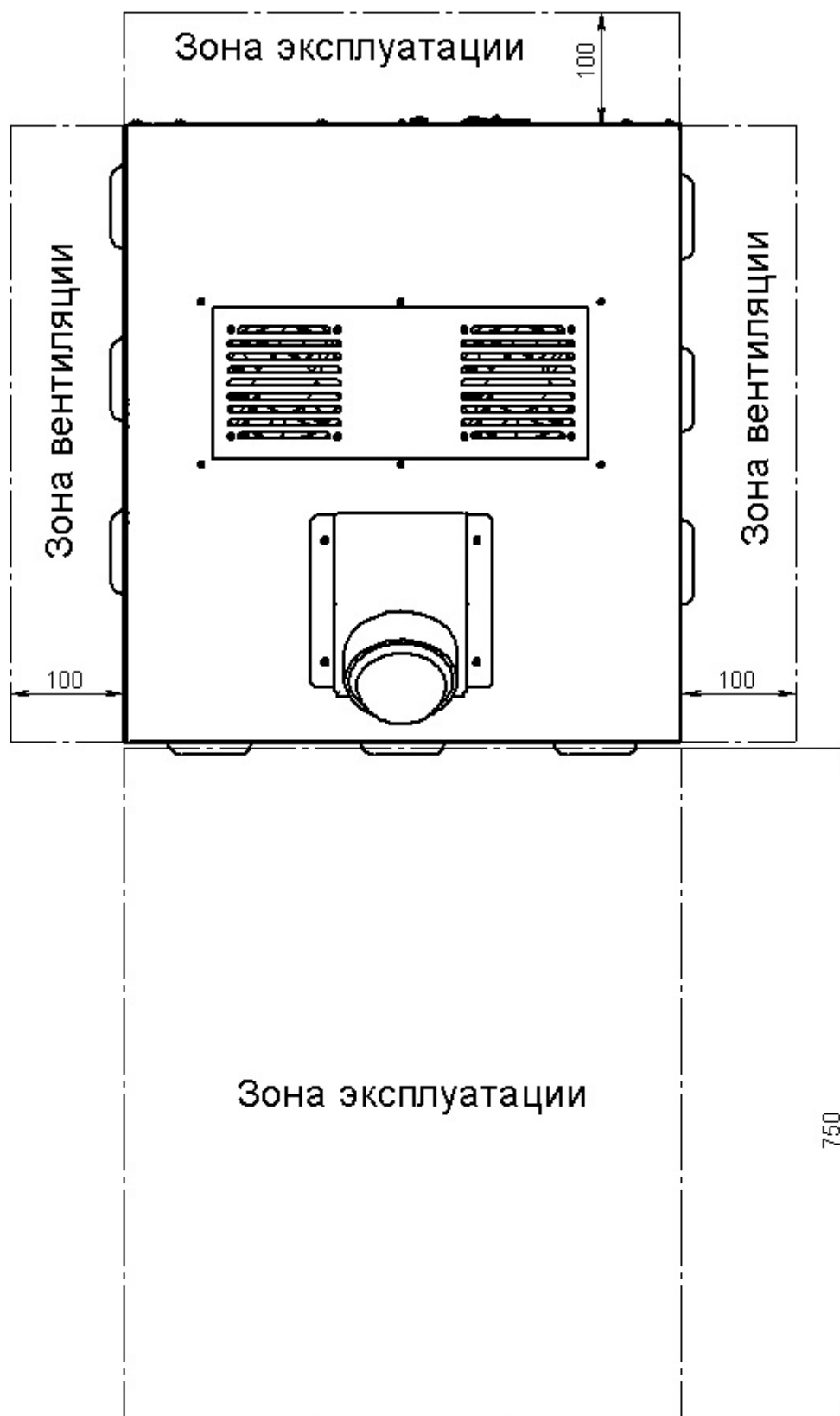
Рисунок 4. Зоны эксплуатации и вентиляции
