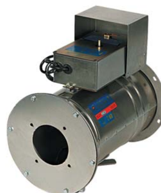
Фланцевый КЛОП®-1 с электромагнитным приводом и пластинчатыми переходами под фланцевое соединение
