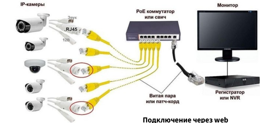
СТАНДАРТНАЯ СХЕМА ПОДКЛЮЧЕНИЯ IP-КАМЕР К РЕГИСТРАТОРУ
