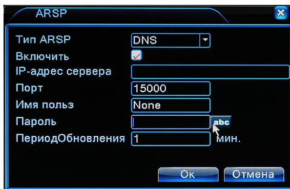
Рис. 4.3.4.8. Настройка. Сетевые службы. ARSP
