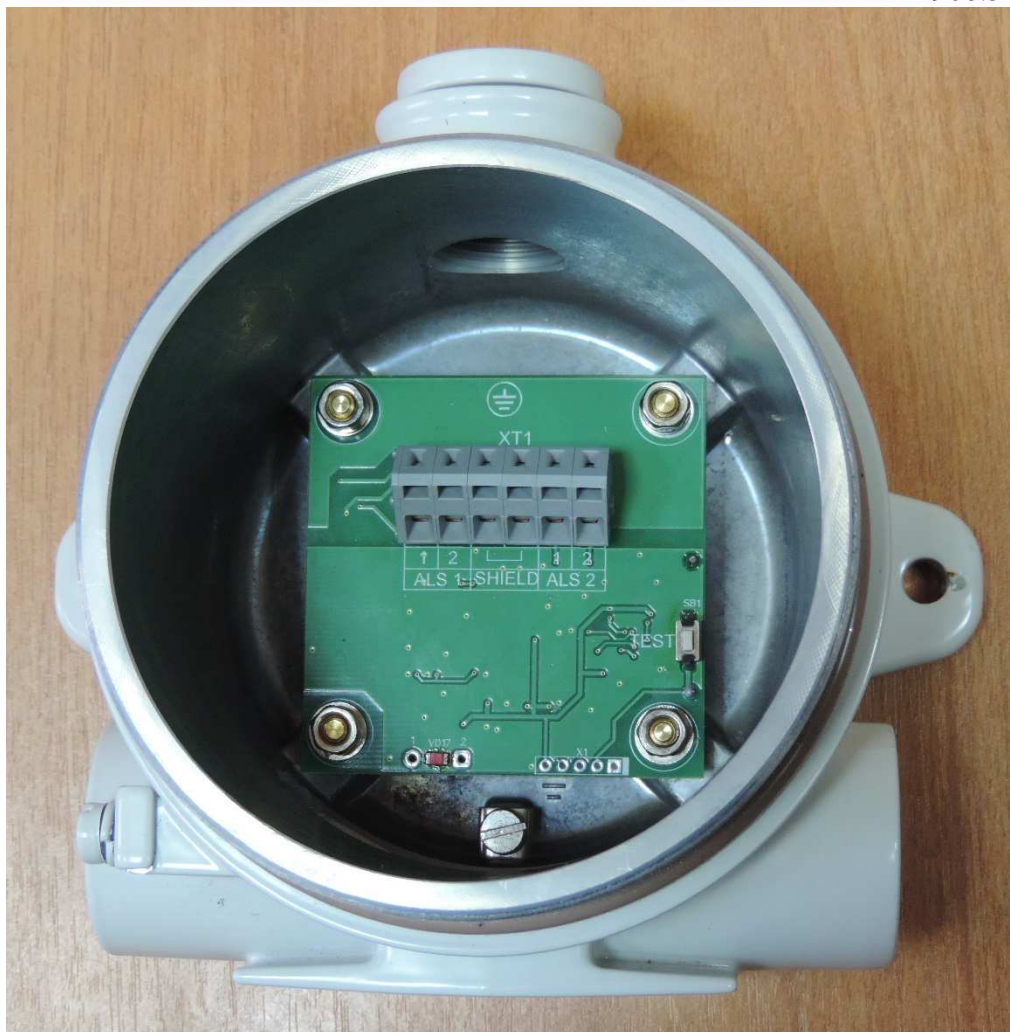
Рис. А.1.6 – Внешний вид коробки коммутационной ККВ14-ИЗ-1-R3. Кабельные вводы не установлены, крышка снята.
