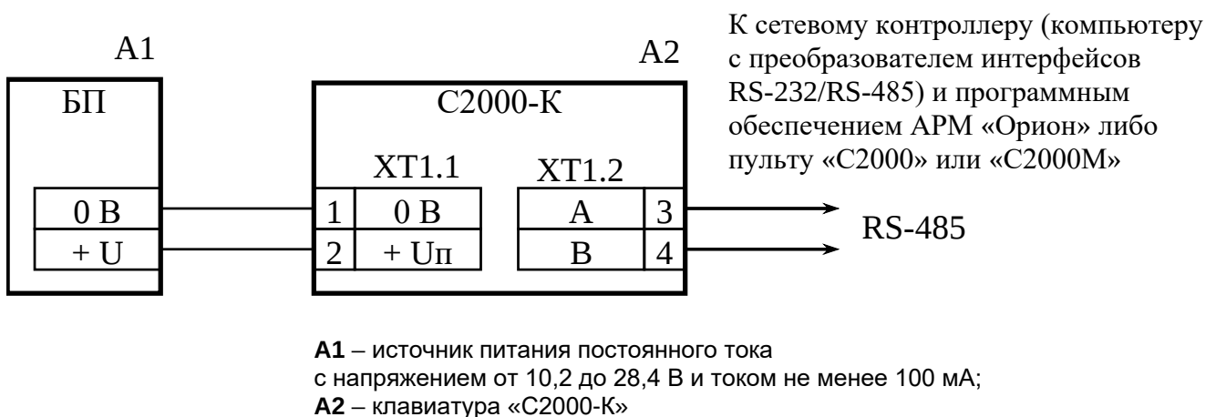
Рисунок 1 Схема подключения клавиатуры «С2000-К» при эксплуатации
