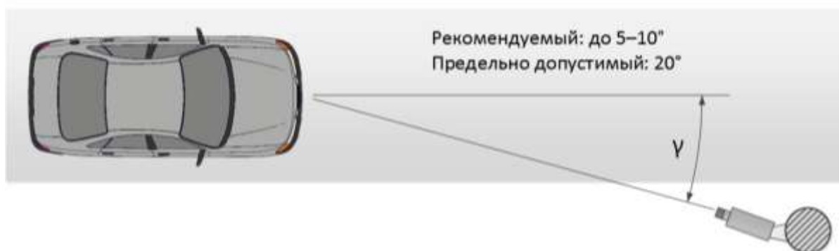
Рис. 6.5. Горизонтальный угол установки камеры
