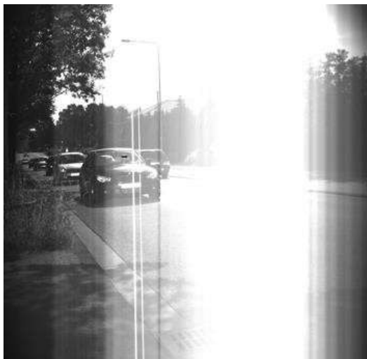
Рис. 6.11. Эффект вертикального ореола у ПЗС-матрицы
