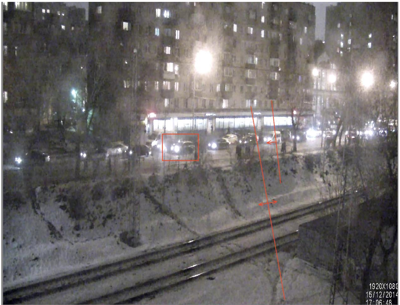
Рис. 181. Траектория объекта и сигнализирование о пересечении линии
