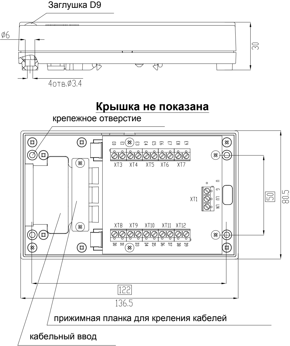
Рис. 2. Габаритные и установочные размеры KM100-7
