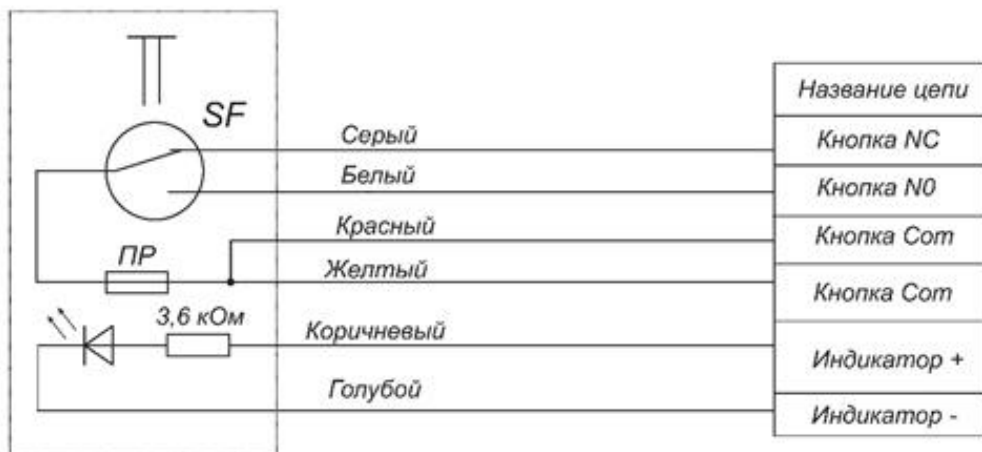
Рисунок 2 – Маркировка выводов изделия AL-BT-S03
