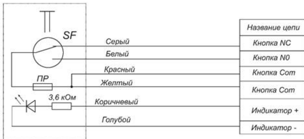
Рисунок 2 – Маркировка выводов изделия AL-BT-S03
