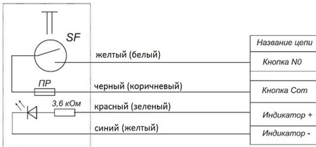
Рис.2 маркировка выводов ВК200 (кнопка)
