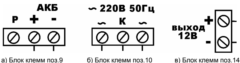
Рисунок 39 – Маркировка блоков клемм ББП
