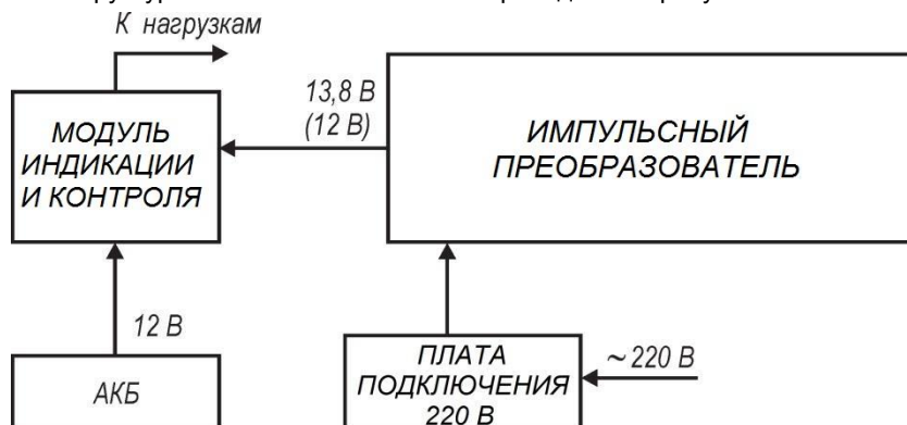
Рисунок 5 – Структурная схема блока питания
