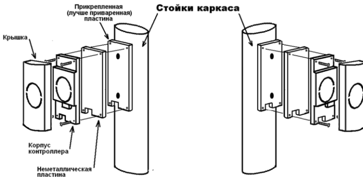
Рисунок 20 – Установка контроллера на общий каркас
