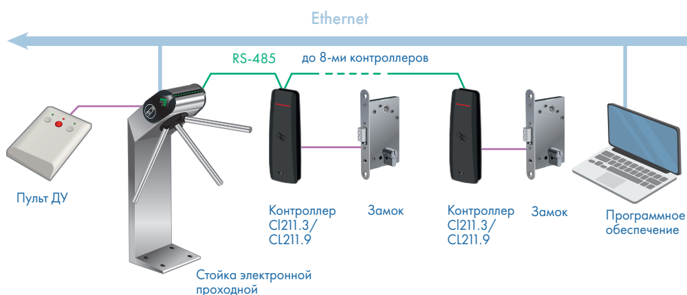
Структурная схема подключения электронной проходной
